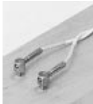
⑧ Poste de mesure de l'humidité du bois avec électrodes à enfoncer
