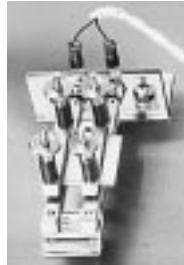
⑨ Prise murale pour poste de mesure avec palpeur de l'humidité d'équilibre du bois et sonde de mesure de Limba
